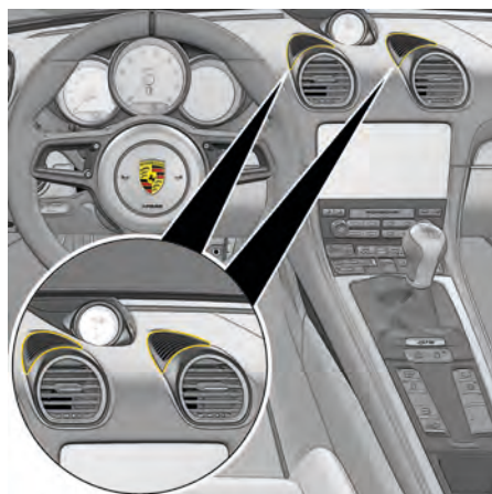
Fig. 64: Upper ventilation panel
