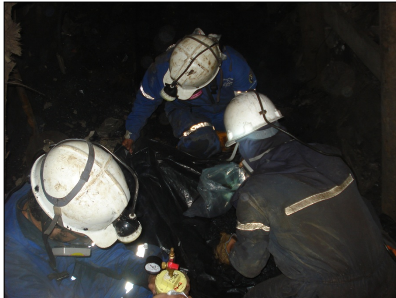
Figura 37. Obtención de muestra en frente de mina para medición de contenido de gas metano.
