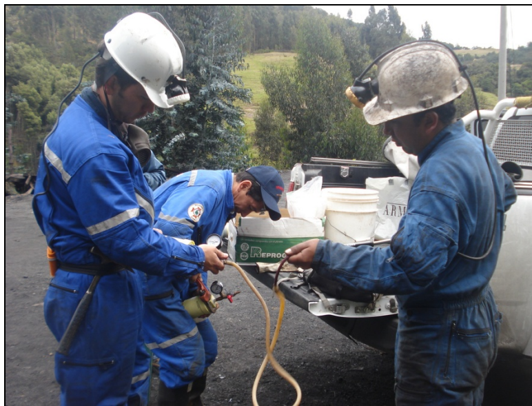
Figuras 36. Pruebas de hermeticidad en los canister. Muestreo frente de mina.
