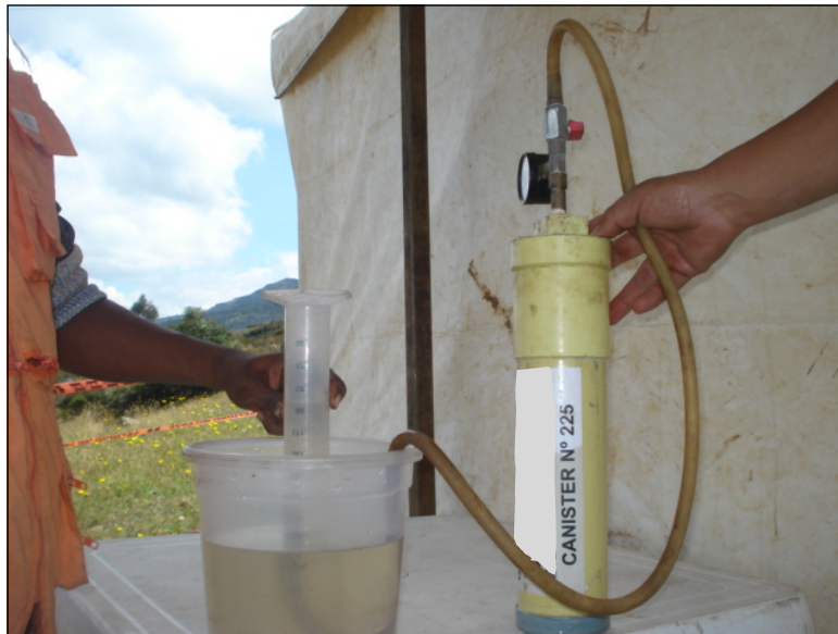
Figuras 38. Sistema de medición del gas perdido en muestras de carbón pozo Samacá-2.
