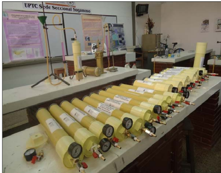
Figuras 34 y 35. Equipos empleados en la medición de gas metano en capas de carbón.
