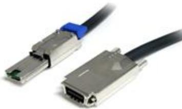
Das 1 m serielle befestigte SCSI-Kabel ISAS88701 wurde für Hochleistungs-Netzwerke, -Server, -Workstations und -Desktops entworfen. Es ist mit einem SFF-8470-Stecker (Infiniband®) und einem SFF-8088-Stecker (externe Mini-SAS) mit Unterstützung für Datenübertragungsraten von bis zu 6 GBit/s ausgestattet. Dieses SFF-8470 bis SFF-8088 SAS-Kabel besteht aus hochwertigen Materialien und wird mit lebenslanger StarTech.com-Garantie geliefert.
