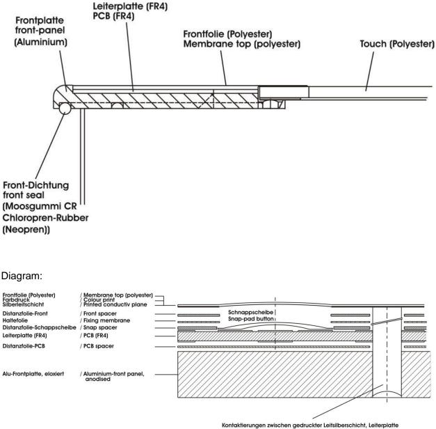
Kontaktierungen zwischen gedruckter Leitsilberschicht, Leiterplatt und eloxalfreier Bohrung der Alu-Frontplatte, durch Leitpaste.
