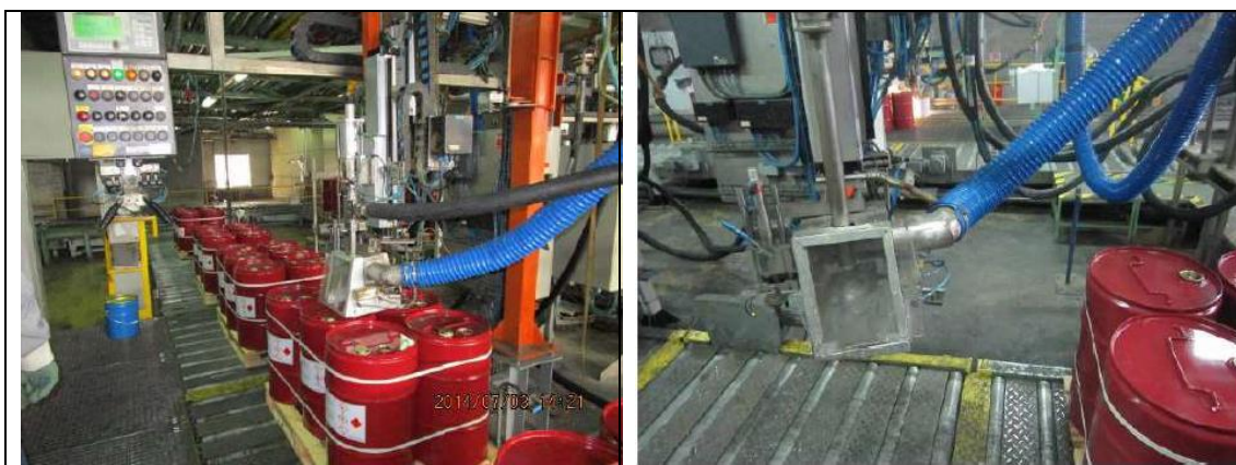
图 5.6-1 灌装线废气收集措施图
