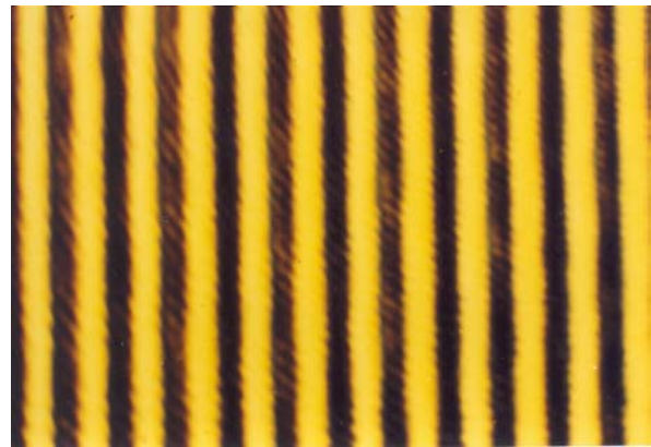
Bild 8: Polarisationsmuster in einem LB-Multilayer (G2, 240 Schichten, ca. 2µm, x50)
