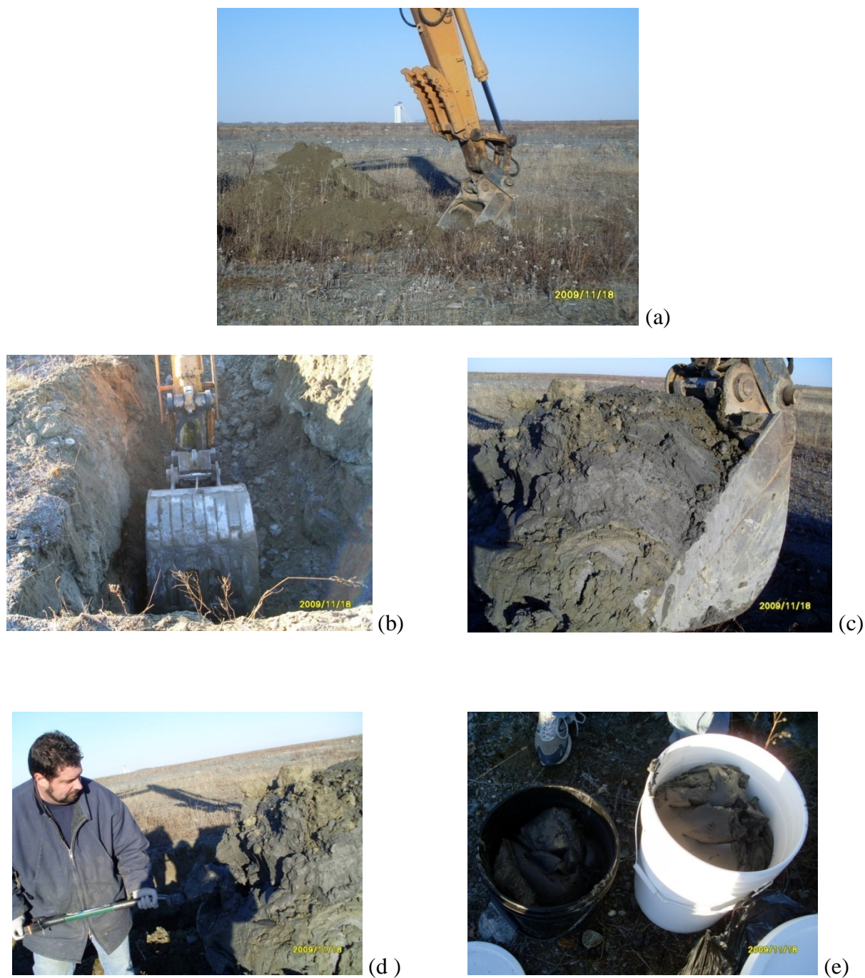
Figure 4.2 : Opérations d'échantillonnage des résidus sulfureux LTA: a) et b) Excavation des couches de la CEBC séparément; c) et d) Échantillonnage de résidus LTA saturés; e) Remplissage des résidus saturés en eau dans les chaudières.
