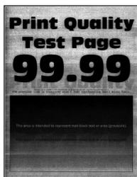
**Remarque :** Avant de résoudre le problème, imprimez les pages de test de qualité d'impression. Sur le panneau de commandes, accédez à **Paramètres > Dépannage > Pages de test de qualité d'impression**. Sur les modèles d'imprimante sans écran tactile, appuyez sur
