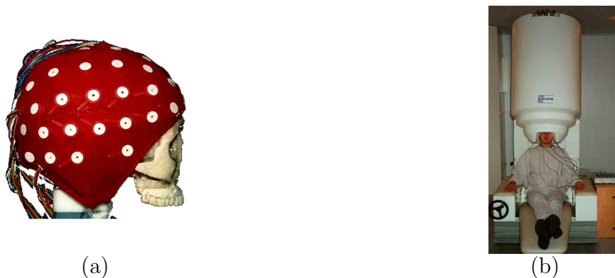
FIG. 1.9 – Système d'acquisition en EEG (a) et en MEG (b) (Illustration d'après web.ccr.jussieu.fr/meg-center/media/cours%20Line/CoursLine01.pdf )
