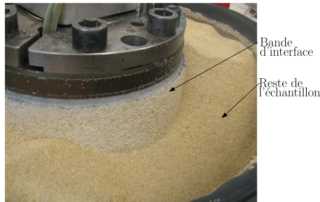
FIGURE 5.11 – Photo prise lors du démontage d'un échantillon d'essai après 14,6 m de cisaillement (Essai VSin002). Une bande d'interface de sable formée de particules fines légèrement cohésives entoure le clou et lui est solidaire. Le reste de l'échantillon ne présente aucune cohésion.
