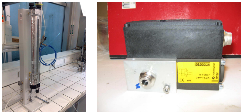
FIGURE 1.6 – Gauche : photo du volumètre de modèle Wille pour la mesure des variations volumiques (max. 0,2 l) de l’échantillon correspondant à la variation de volume de l’eau de confinement. Il sert aussi pour la transmission de la pression (max. 1 MPa) provenant de la servovalve. Droite : photo de la servovalve Joucomatic d’une capacité de 1 MPa.
