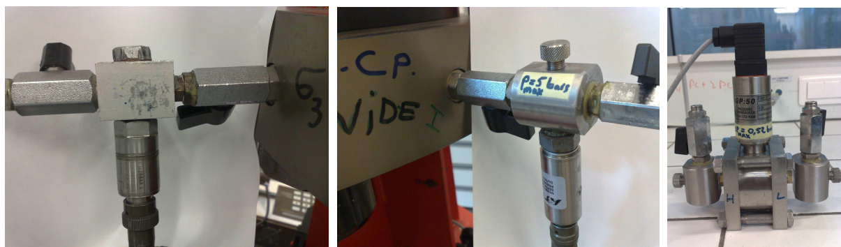
FIGURE 1.7 – Gauche : Capteur de pression relative Schlumberger (2 MPa) pour la pression de confinement \sigma_e (ou \sigma_3 ). Centre : Capteur de pression relative AST (0,5 MPa) pour la pression interstitielle (ou contre-pression CP) et bloc de purge. Droite : Capteur de pression différentielle FGP (0,063 MPa) et blocs de purge connectés à des robinets. On aperçoit les indications H : High et L : Low.
