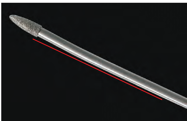
Unrund laufende Instrumente aussondern. Discard non-concentrically running instruments. Éliminer les instruments qui ne tournent pas rond.
