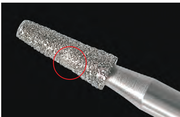
Diamantierung beschädigt. Damaged diamond coating. Grain diamanté endommagé.
