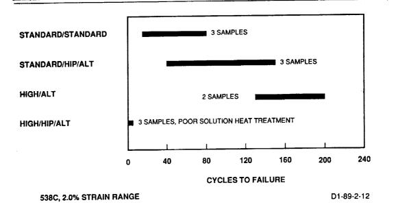
ADVANCED PROCESSING OF PWA 1480 LOW CYCLE FATIGUE FRACTOGRAPHY
