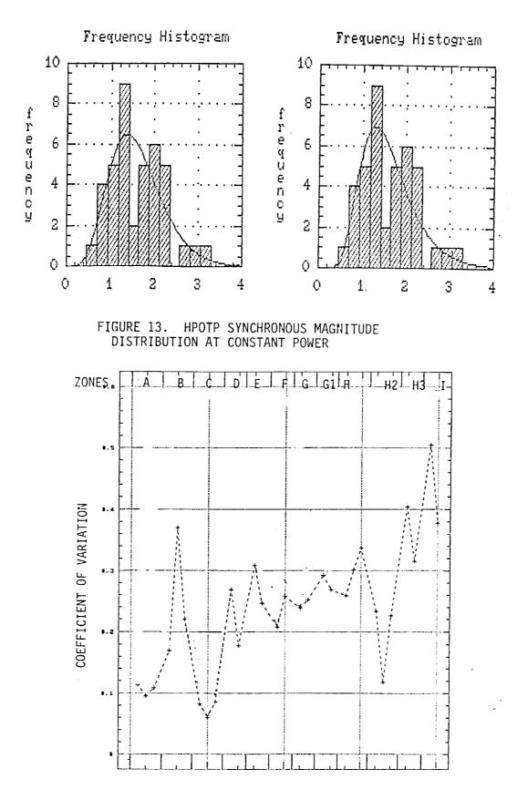
FIGURE 14. SSME ZONAL VIBRATION COMPOSITE GRMS COEFFICIENTS OF VARIATION
