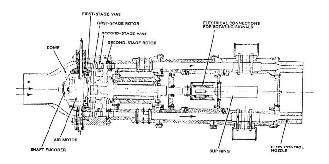
Figure 2 SKETCH OF MODEL TO HOUSE TURBINE STAGE
