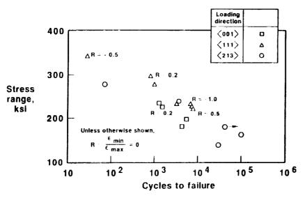
1200F PWA 1480 STRAIN CONTROLLED FATIGUE
