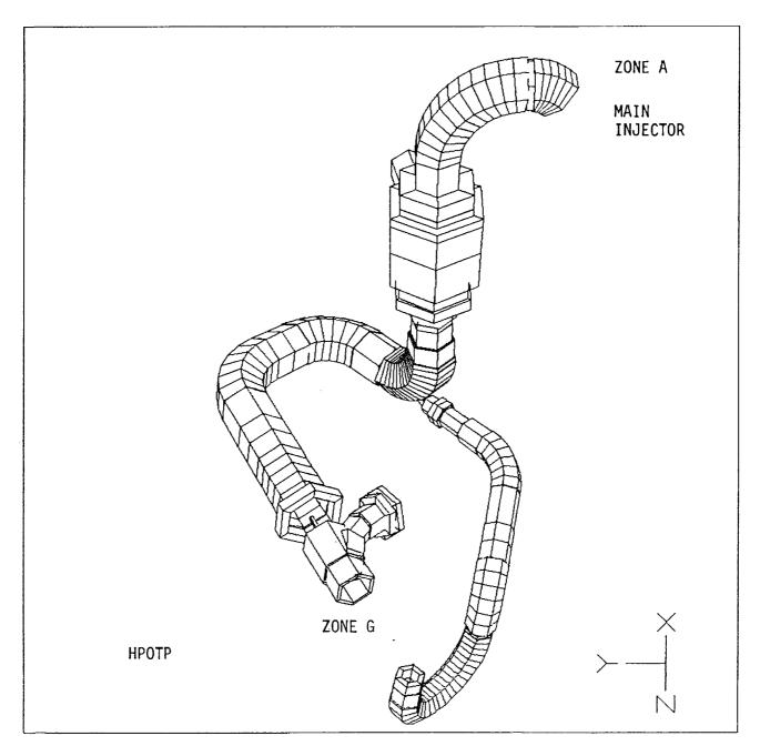
FIGURE 10. HPOTP DISCHARGE DUCT
