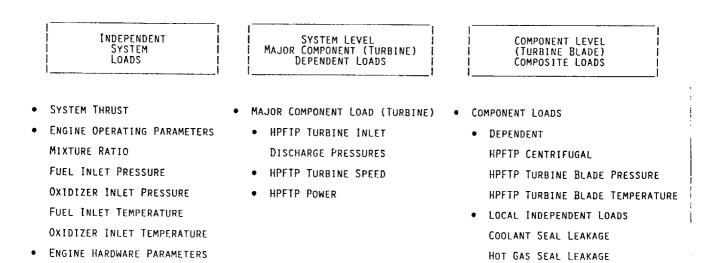
FIGURE 4. COMPOSITE LOADS OF THE HPFTP TURBINE BLADE FOR THE PROBABILISTIC STRUCTURAL ANALYSIS
