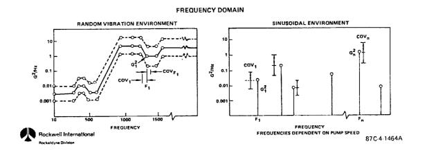
FIGURE 12. RANDOM AND SINUSOIDAL VIBRATION
