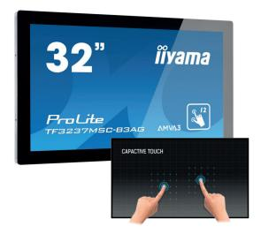
Mit einer 1.920 x 1.080 Full-HD Auflösung und der Projective Capacitive 12 Punkt Touch Technologie bietet er eine nahtlose und präzise Touch Reaktion.
