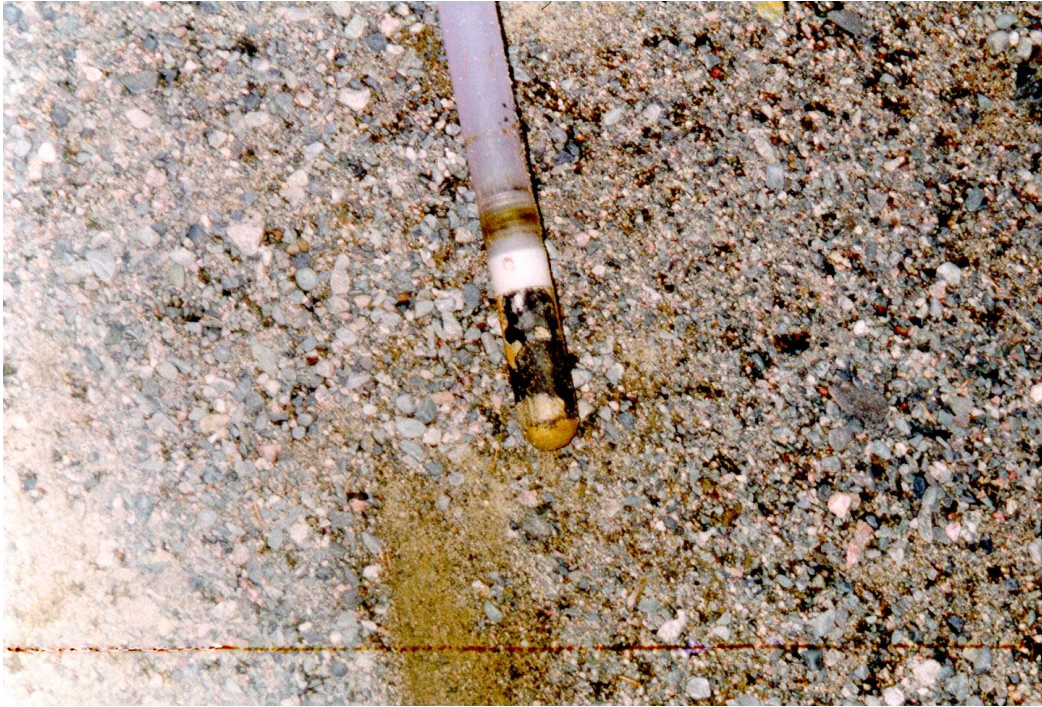
Figure 4.60 Colmatage d'une pierre céramique d'un tensiomètre
