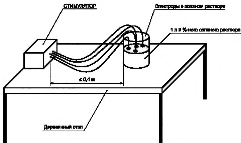
Рисунок 202.101 — Схема испытания
