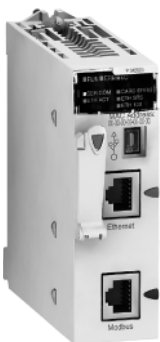
Port Ethernet intégré au processeur, exemple de processeur Modicon M340 BMX P34 2020/2030
