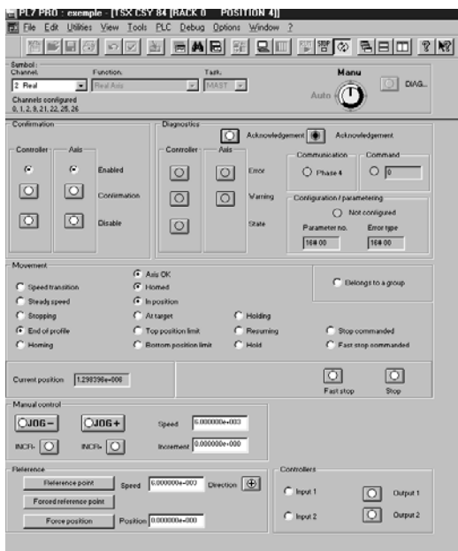
Mise au point sous logiciel PL7 Pro
