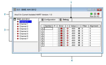
The output module **Debug** tab:
