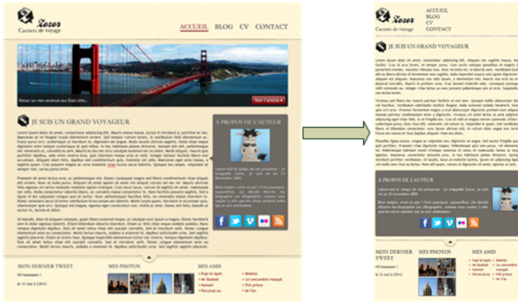
FIGURE 18.3 – Le même site, présenté différemment en fonction de la largeur de l'écran
