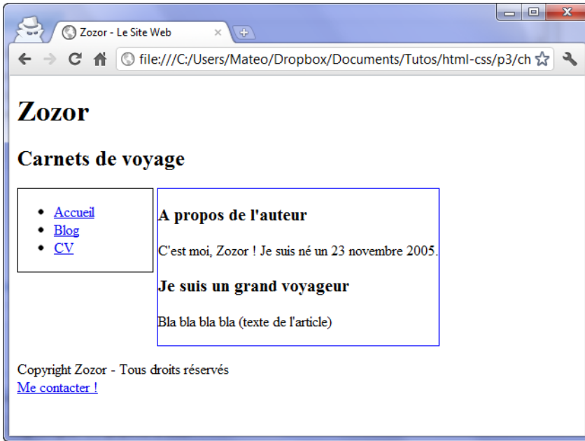
FIGURE 13.6 – Le menu et le corps sont alignés en haut et côte à côte
