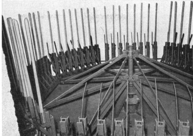
Bild 897. Ansicht der karussellartigen Anordnung der Stielbiegemaschinen gemäß Bild 896, Bauart A. Griesinger Maschinen- und Apparatebau, Stuttg.
