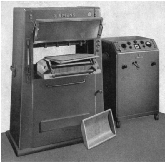
Bild 914. Ansicht einer Formpresse für gebogene Sperrholzteile mit Hochfrequenzbeheizung, Bauart Siemens-Schuckert-Werke AG., Erlangen.
