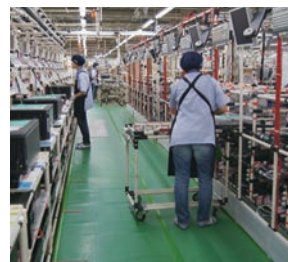
高負荷ランニング試験 電源のOn-Off試験、HDのリードライト試験、データ負荷試験などを行う。
