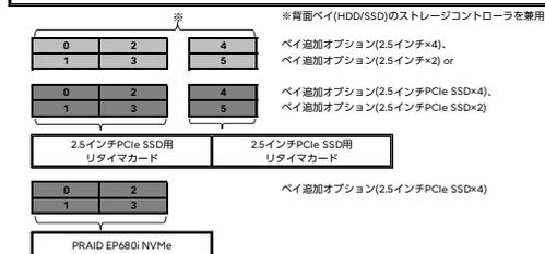
背面(PCIe SSD×4、×2)：2.5インチPCIe SSD用リタイマカード
