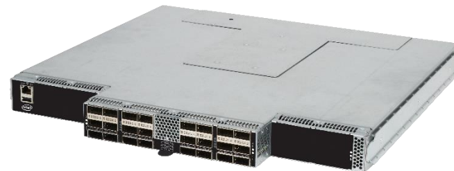
24-port Edge Switch
