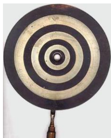
Obr. 4 – Keratoskop navržený A. Placidem roku 1880 zdroj: Herrmann, C., Ludwig, U., Duncker, G. Korneale Topographie. Der Ophtalmologie, 2008, 105, pp. 193-206.
