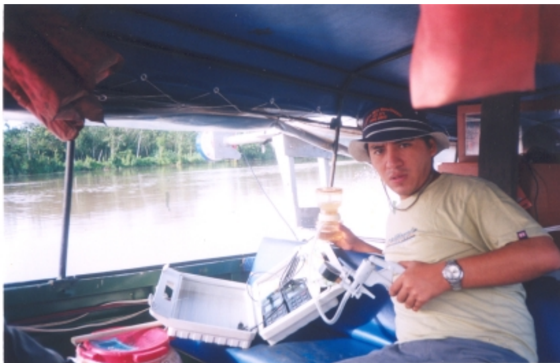
Foto 5. Equipo de toma de muestra de agua, se puede observar el conductivimetro, el phmetro y la bomba de filtración.
