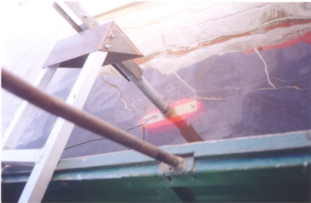
Foto 3. Vista del Transductor tipo Combi-d de la Ecosonda y de su estructura
