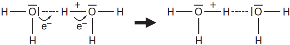
Figure III-7 - Schéma du mécanisme de Grotthuss [16]
