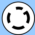
P9S19A の 入力電源プラグ形状 ツイストロック コネクタ 三相 200V 30A 【NEMA L15-30P】
