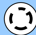
P9Q54A / P9Q53A の 入力電源プラグ形状 ツイストロック コネクター 三相 200V 30A 【NEMA L15-30P】
