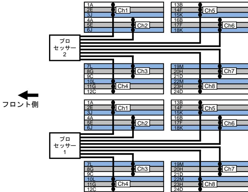
Synergy 620 Gen9 コンピュート モジュールのプロセッサとメモリ スロットのレイアウト
