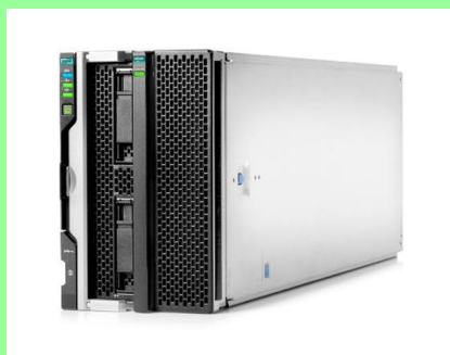
GPU 拡張モジュールを装着した Synergy 480 Gen9 コンピュート モジュール
