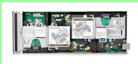
SY480 用 PCIe カード拡張モジュール
