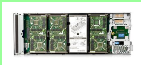
SY480 用 Multi GPU PCIe カード拡張モジュール
