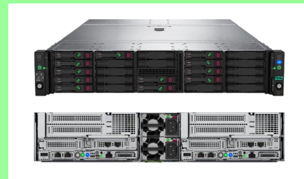
HPE SimpliVity 190 Gen10 サーバー ノードを 2 基搭載した HPE SimpliVity 2600 Gen10 Chassis (上：正面、下：背面)
