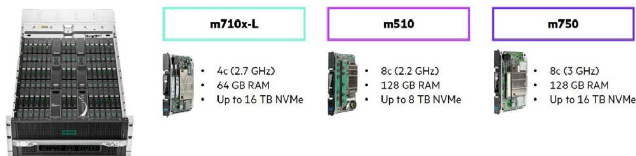
図2。DataStax Enterprise向けのMoonshotブレードファミリーを備えたHPE Moonshot 1500シャーシ
