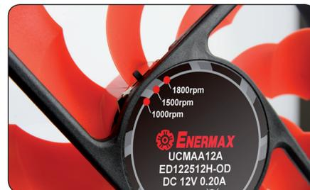
Mit einem kleinen Schalter an der Lüfternabe kann die Lüftergeschwindigkeit in drei Stufen begrenzt werden: Ultra Silent Mode (1.000 1/min) / Silent Mode (1.500 1/min) / Performance Mode (1.800 1/min).
