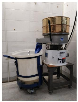
Figure 21: Séparateur électrique Sweco Vibro-Energy (Modèle LS18S5P3).
