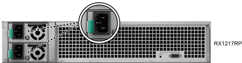
**Remarque :** Le RX1217RP est équipé d'un système d'alimentation redondante, permettant le raccordement de deux cordons d'alimentation. Le système peut être allumé avec un seul cordon d'alimentation, mais nous vous recommandons d'utiliser deux cordons d'alimentation pour éviter les pannes d'alimentation inattendues.
