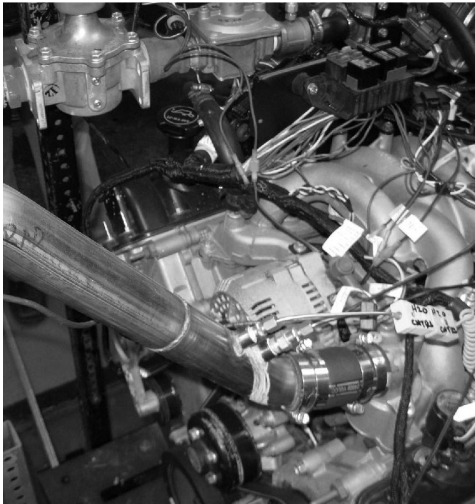
Рисунок 20. На рисунке также показан тот же дизель генератор, что и на рисунке 16, который проходит модернизацию с целью перевода на более экономичный и эффективный, а также экологически более чистый вид топлива
