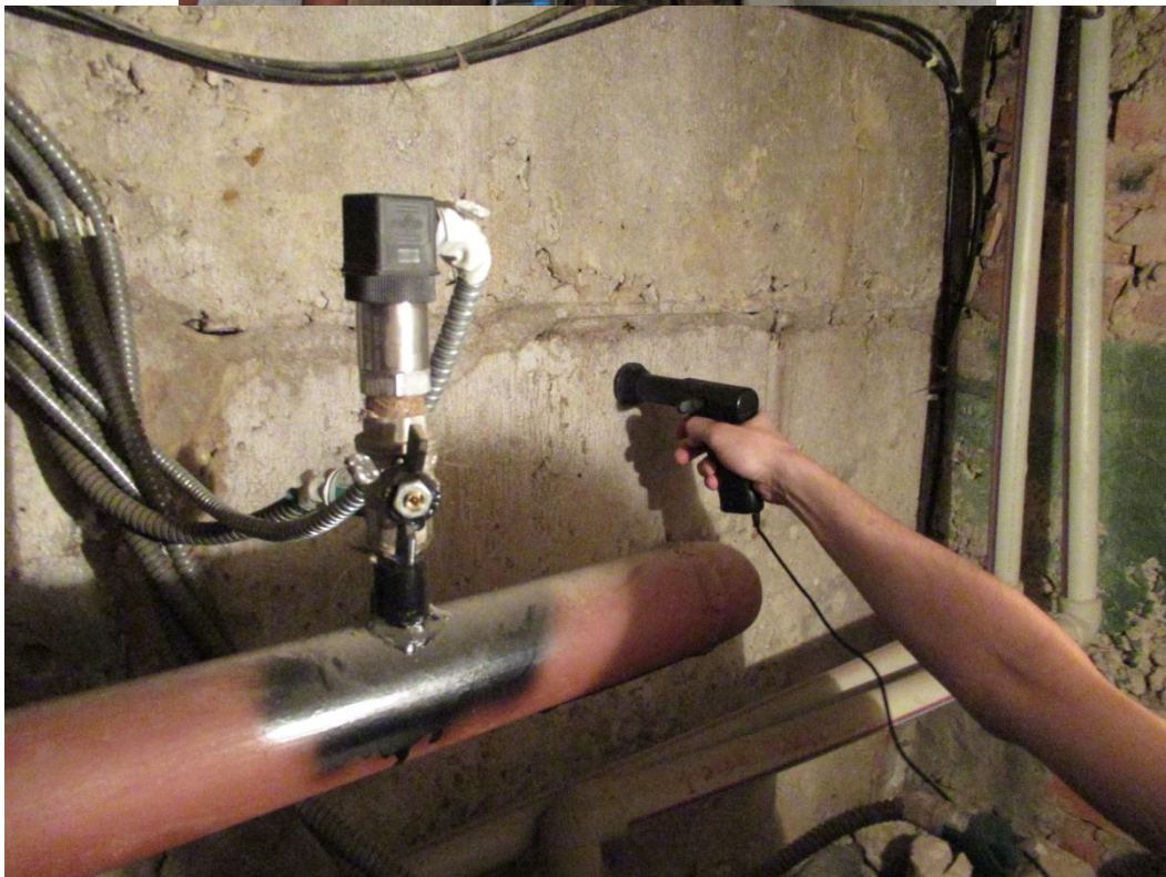
№6 Определение прочностных характеристик материала фундаментного блока
