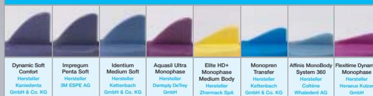
\* Halbschiffen-Test nach der Methode der Tufts University, Boston. Zeitpunkt der Belastung: 45 Sek. nach Mischbeginn. Je höher die Halbschiffen, desto besser fließt das Abformmaterial.
