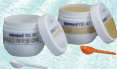
Scanbares Knetsilikon, additionsvernetzend (1:1) für die puderfreie optische 3D-Registrierung und Datenerfassung im CAD/CAM/CIM-Bereich; Endhärte: Shore A 95
