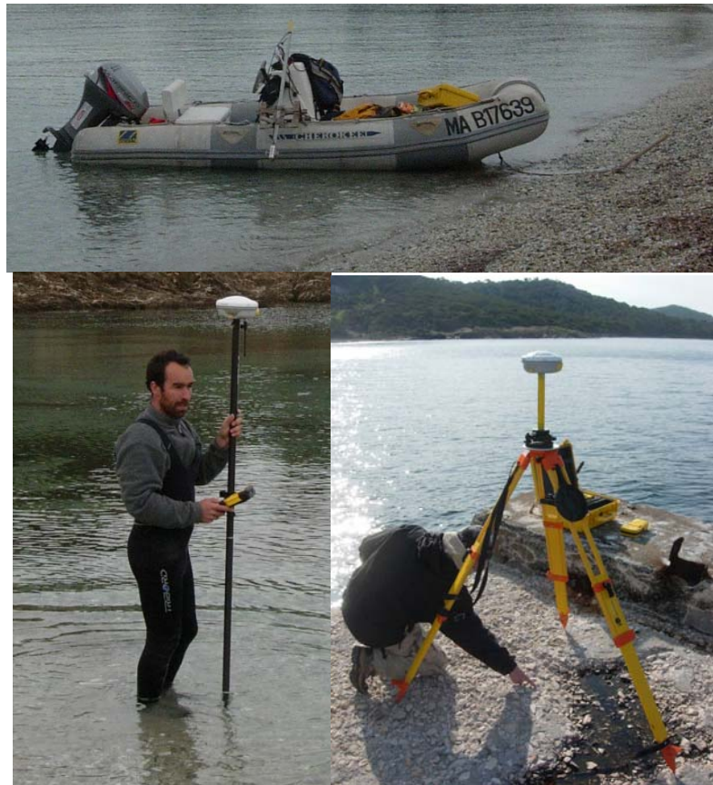
Photographie 7. Matériel embarqué (Sondeur Tritech 500, centrale d'acquisition Hypack, Zodiac 4,70 m). Arpenteur équipé d'une perche et d'un DGPS TRIMBLE 5800 RTK. Station de base du DGPS positionnée sur un point géoréférencé. (Plage de Notre Dame, île de Porquerolles).
