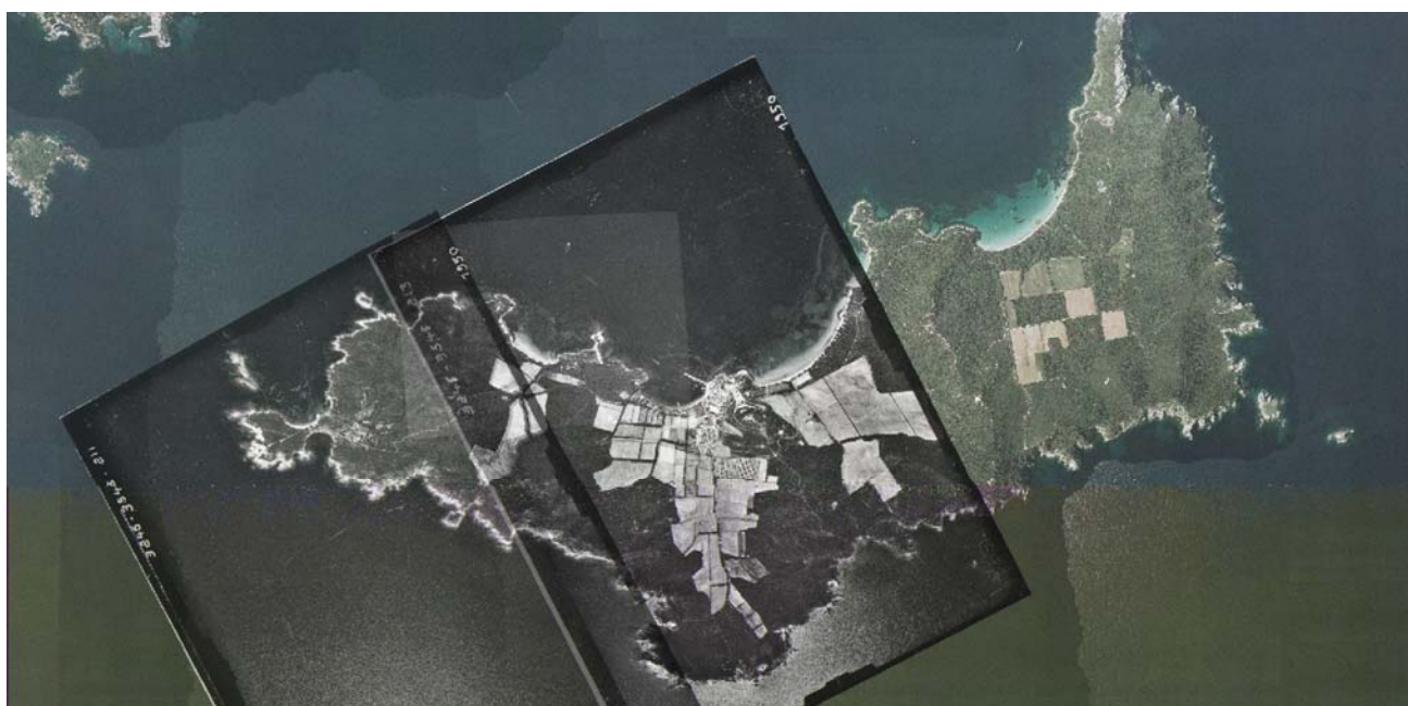
Fig. 83. Recalage des clichés de 1950 sur la mosaïque de l'ortho photographie de 1998 servant de référence (secteur de Porquerolles).
