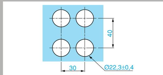
Montage sur circuit imprimé ▶36020◀
