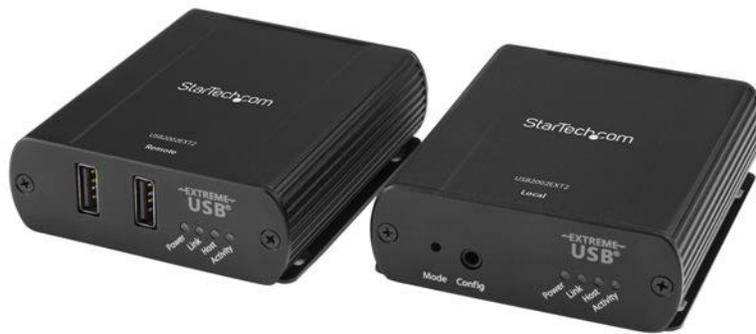
L'extendeur USB sur Cat5/Cat6 USB2001EXT2 vous permet de prolonger vos connexions USB 2.0 sur des distances pouvant atteindre 100 mètres avec un câblage Ethernet Cat5 ou Cat6 standard.
