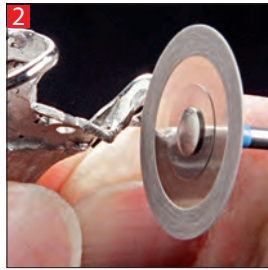
2 Обработка металлических каркасов. Trimming of metal framework.
