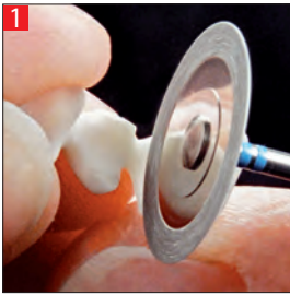
1 Обработка оксид-циркониевой керамики. Trimming of sintered zirconia.
