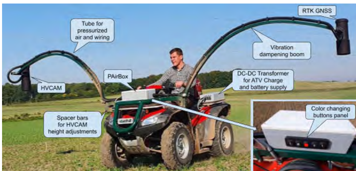
Figur 1: Komponentoversigt over Dual-HVCAM-systemet. Honda ATV inklusive etiketter.
