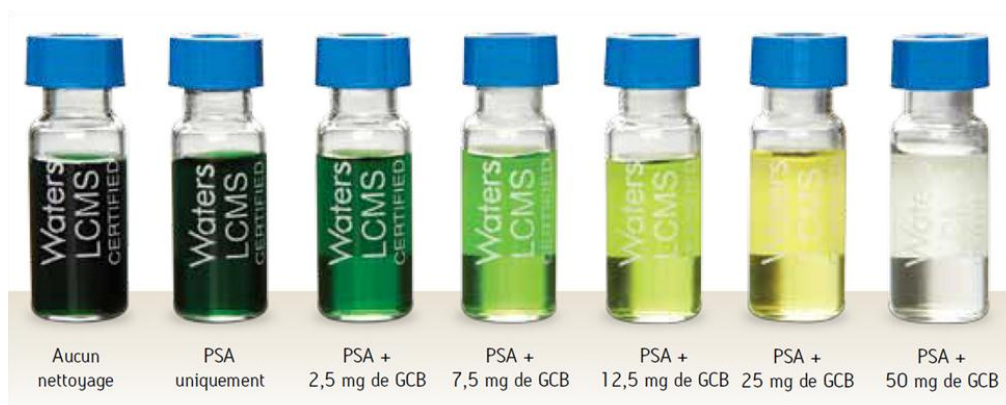
Figure 21 : Effet de l'emploi croissant de GCB sur un extrait QuEChERS d'épinard (Illustration tirée de la plaquette commerciale Waters)
