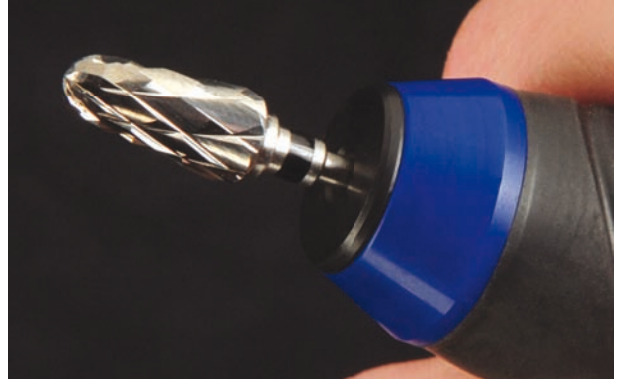
Правильная глубина погружения. Correct insertion depth.
