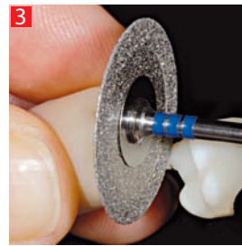
3 Обрезание литников. Separation of press sprues.
