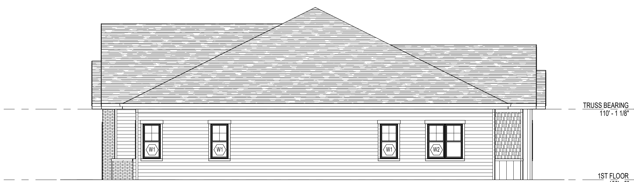
2 NORTH ELEVATION SCALE: 1/8" = 1'-0"
