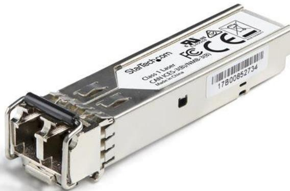
El modelo SFP1GTEMCSST es un módulo transceptor SFP por Cobre compatible con el modelo SFP-1G-T de a Dell EMC diseñado, programado y probado para su funcionamiento con routers y switches de la marca Dell EMC™. Ofrece conectividad confiable a 1 GbE, a través de cable de Cobre, para redes compatibles con 1000Base-T , a una distancia máxima de hasta 100 m.
