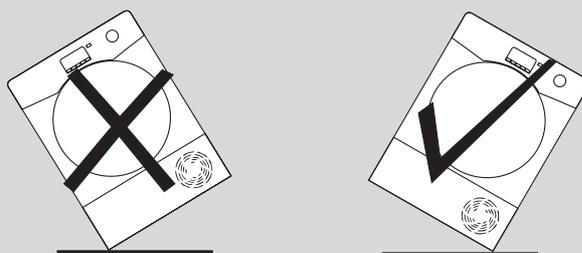
Si le produit est transporté différemment, attendez au moins 4 heures avant d'allumer l'appareil, ceci afin que le gaz liquide retourne dans le compresseur. En cas de non respect de cette procédure, le compresseur pourrait être endommagé.
