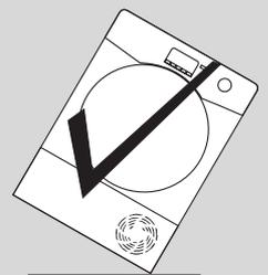
Wenn das Gerät in eine andere Lage transportiert wurde, warten Sie mindestens 4 Stunden, bevor Sie es einschalten, damit sich die Flüssigkeit im Kompressor wieder stabilisieren kann. Tun Sie es nicht, können Schäden am Kompressor die Folge sein.
