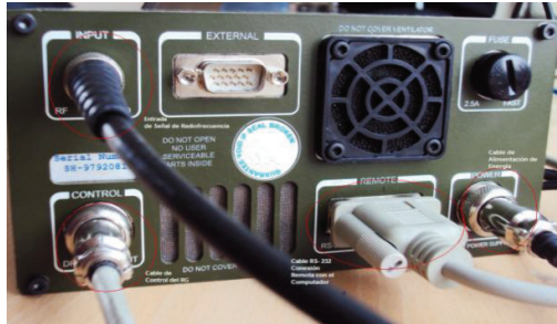
Figura 4.2 Conexiones en el Receptor Radiogoniometro
