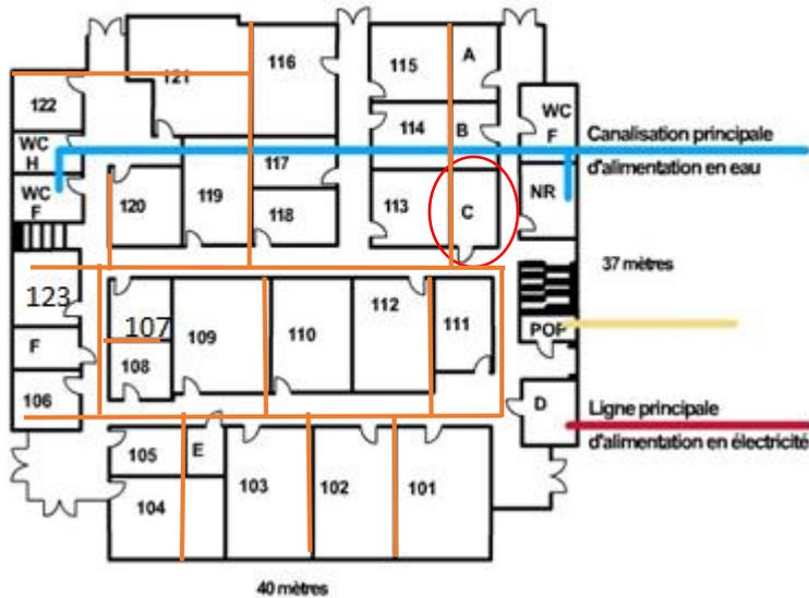
Schéma du réseau câblé au 1<sup>er</sup> étage du bâtiment principal.
