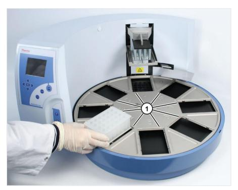
Figure 41. Load the tip-plate
