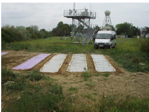
3.11. ábra. A fóliák kihelyezése közvetlenül a sugárzásmérő közelében (2002. június 06.), majd állapotuk 2002. augusztus 15-én.
