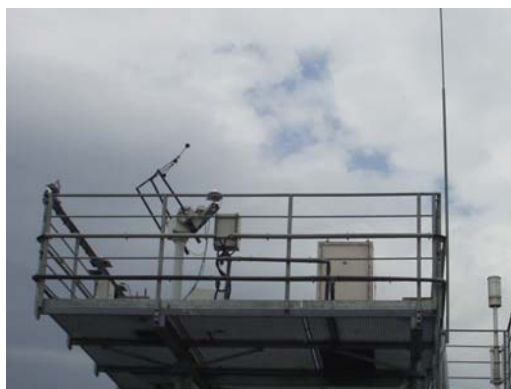
3.6. ábra. A környezeti légállapot- és sugárzásmérő rendszer.
